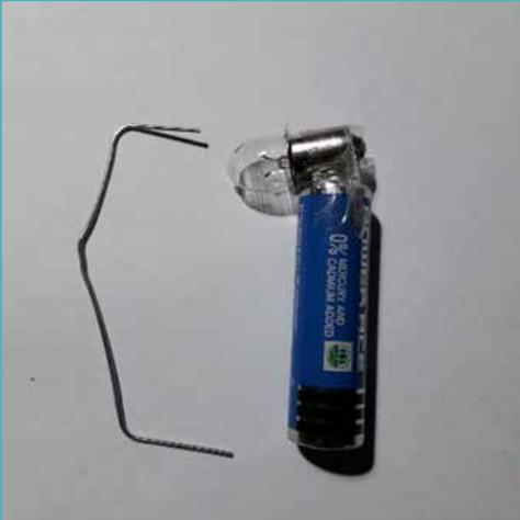
Finalmente, fija con cinta un extremo del clip al polo negativo y tocar con el extremo libre el pie de contacto eléctrico de la ampolla, y observarás lo que sucede.
